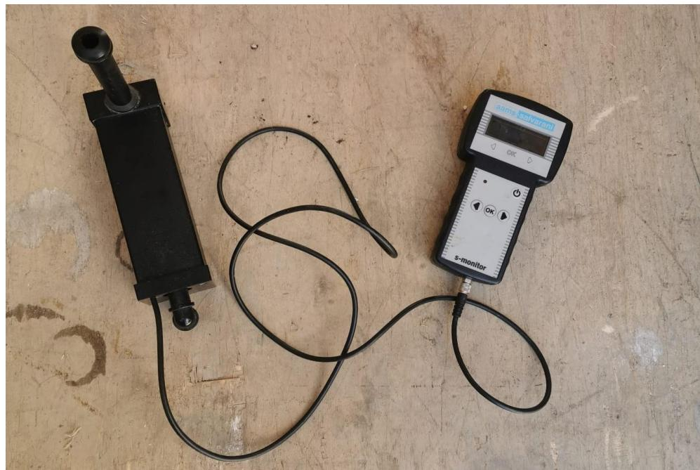
Slika 7. Ispitni uređaj za pojedinačno mjerjenje protoka mlaznica
