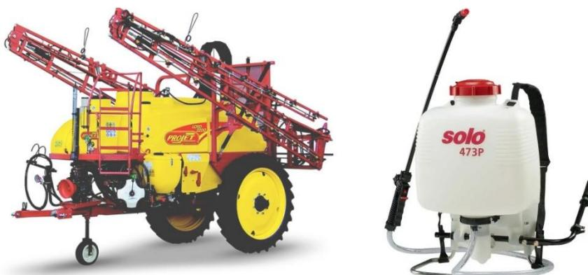
Slika 19. Vučena i ručno vučena (leđna) prskalica (Izvor: [www.messis.hr](http://www.messis.hr); [www.solo.hr](http://www.solo.hr))
