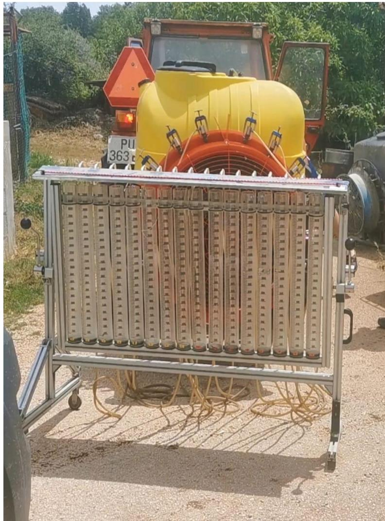
Slika 6. Ispitni uređaj za mjerjenje protoka mlaznica orošivača s menzurama
