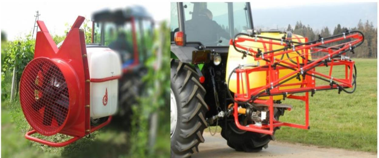
Slika 20. Agromehanika AGP 200 orošivač i Agromehanika AGS 200 prskalica
