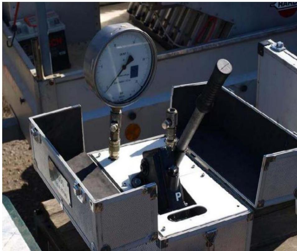
Slika 9. Uređaj za mjerjenje ispravnosti rada manometra
