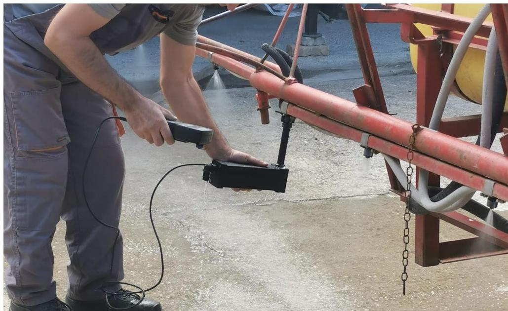
Slika 8. Mjerenje protoka mlaznica kod prskalice ispitnim uređajem za pojedinačno mjerjenje protoka mlaznice (Autor: Ostojić, L.)
