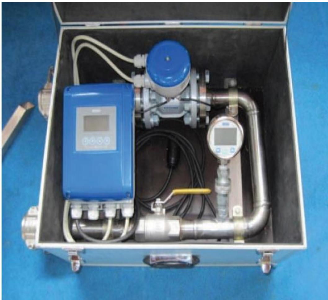
Slika 3. Uređaj za mjerjenje protoka crpke (Izvor: [www.sestar.irb.hr](http://www.sestar.irb.hr))
