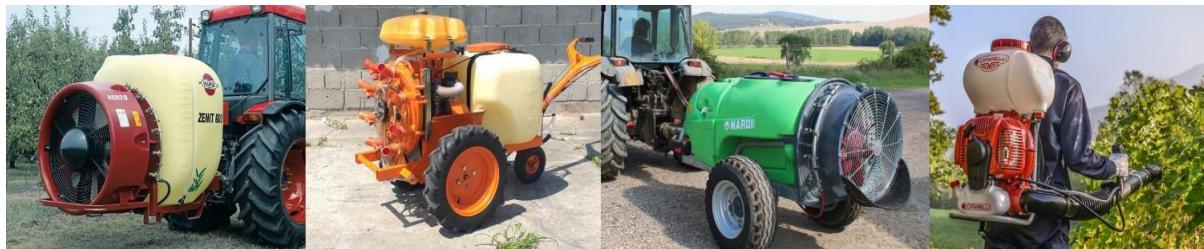
Slika 17. Nošeni, samohodni, vučeni, ručno vučeni (leđni) orošivači
