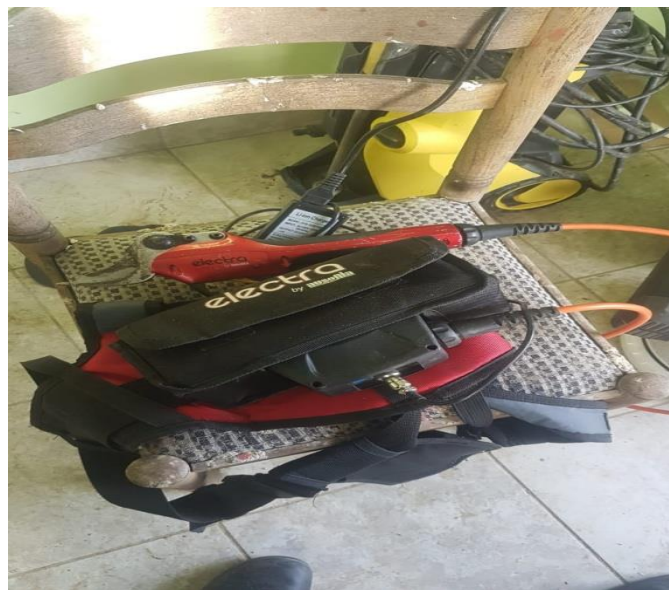
Slika 6: Električne škare za ručnu rezidba (Izvor: vlastiti izvor)
