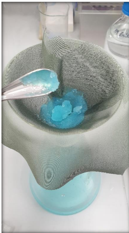
Slika 3.2.2. Odvajanje mikročestica bakrovog alginata od tekuće faze
