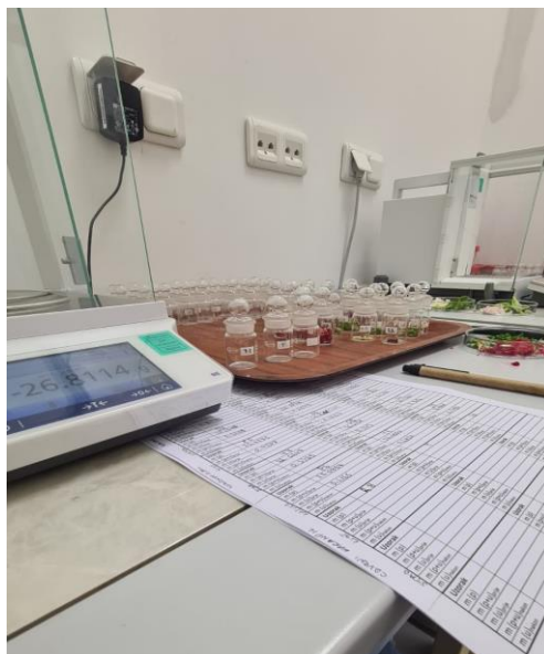
Slika 10. Priprema uzoraka za određivanje sadržaja vode (izvor: vlastiti)
