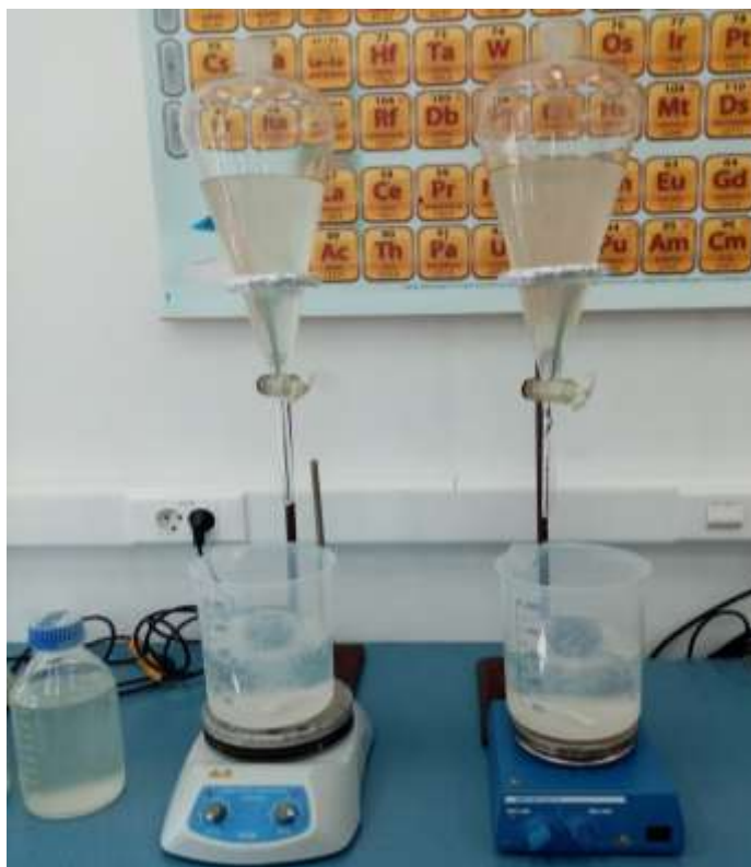
Slika 5. Priprava mikrokapsula pomoću lijevka za odjeljivanje
