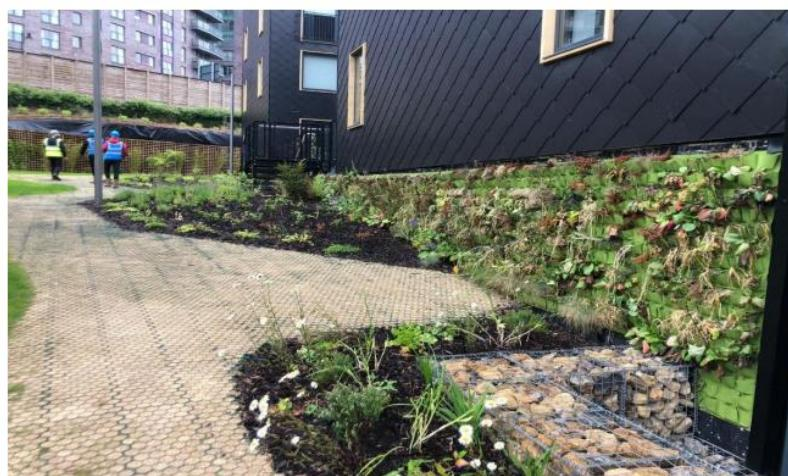
Slika 4.4.4. Prikaz propusnog opločenja, vertikalnog vrta, te biljaka za pročišćavanje vode. Climate Innovation District.
