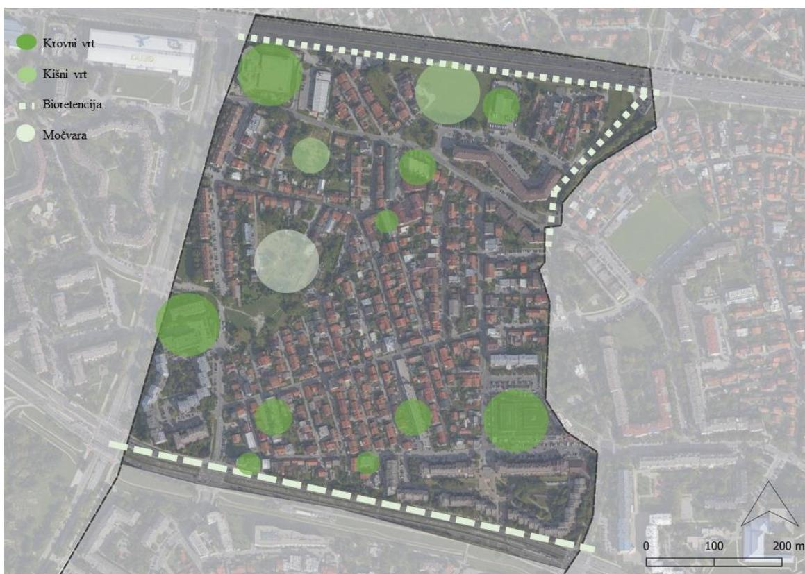
Slika 8.2.1.6. Prikaz prijedloga primjene metoda zelene gradnje.
