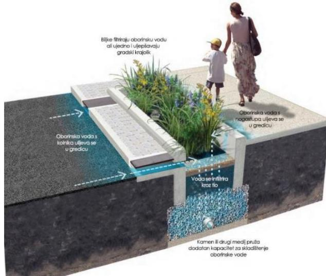
Slika 3.3.5. Presjek kišnog vrta.
