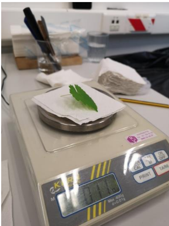
Slika 3.3.2. Određivanje mase biljnog materijala za detekciju virusa
