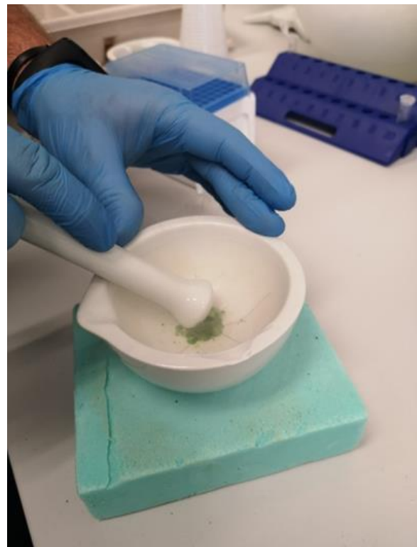
Slika 3.3.3. Usitnjavanje biljnog tkiva korištenjem tekućeg dušika
