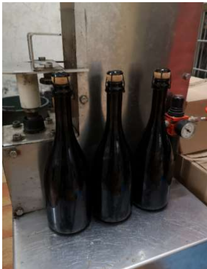
Slika 2.9. Boce zatvorene plutenim čepom i mrežicom Izvor: Šikač I.
