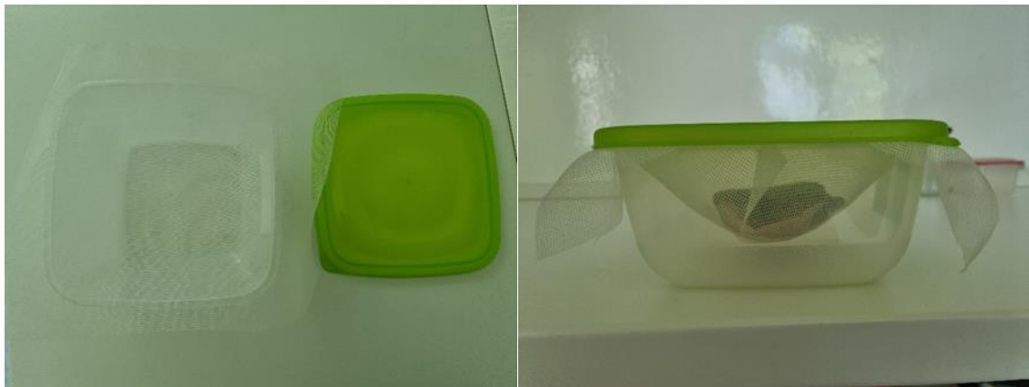
Slika 4.4.1. Prazna posuda sa mrežicom korištena i uzorak na mrežici u zatvorenoj posudi pripremljen za odmrzavanje
