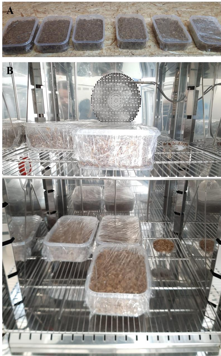
Slika 8. A) Prikaz supstrata sa micelijem u kalupima B) Prikaz kalupa stavljenih u komore
