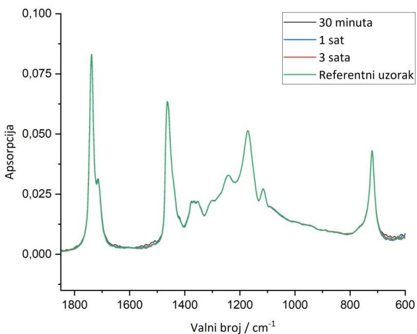
Grafikon 4.4. FTIR-ATR spektri uzorka 3HR tretiranog različitom duljinom trajanja toplinskog tretmana pri  $120\text{ }^{\circ}\text{C}$  (područje "otiska prsta":  $1800\text{-}600\text{ cm}^{-1}$ )
