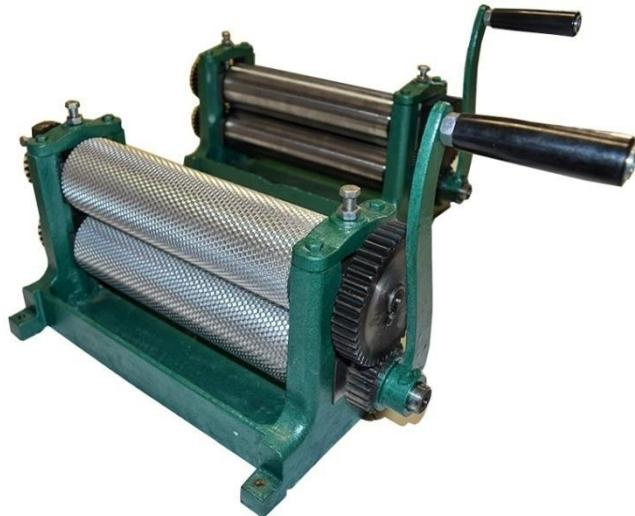
Slika 2.7. Valjak za izradu satnih osnova
