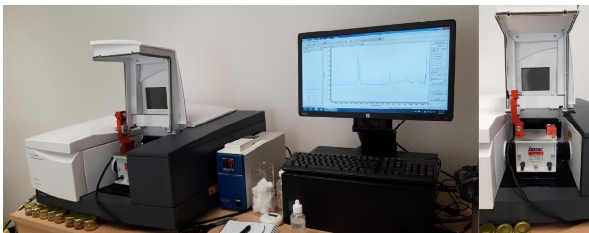
Slika 3.5. FTIR spektrometar (lijevo)s ATR instrumentalnim dodatkom (desno)
