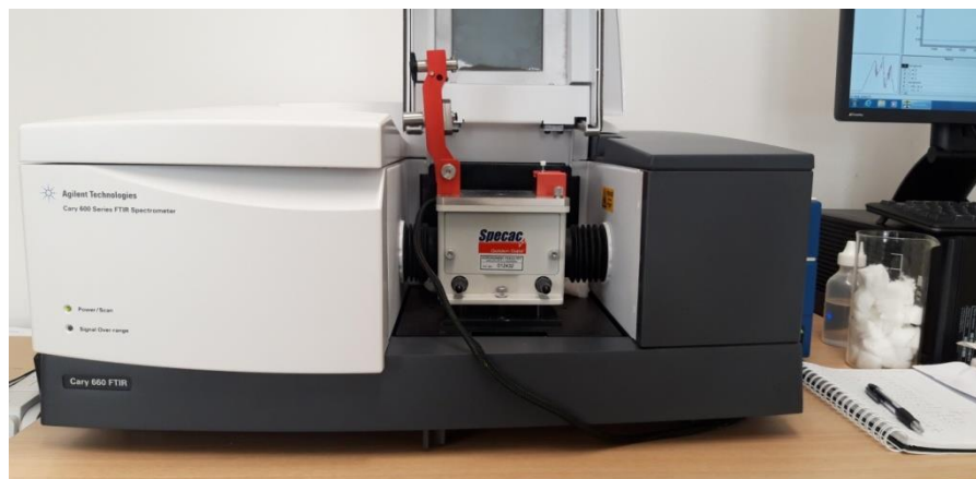
Slika 2.9. Infracrveni (FTIR) spektrometar s ATR instrumentalnim dodatkom
