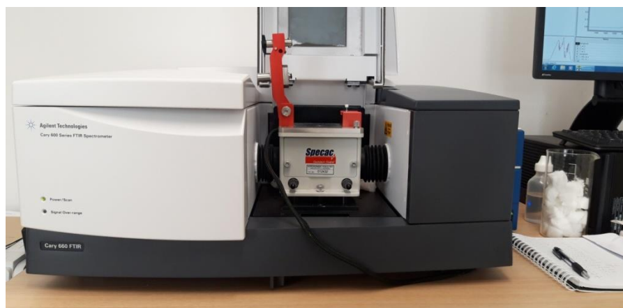
Slika 2.9. Infracrveni (FTIR) spektrometar s ATR instrumentalnim dodatkom
