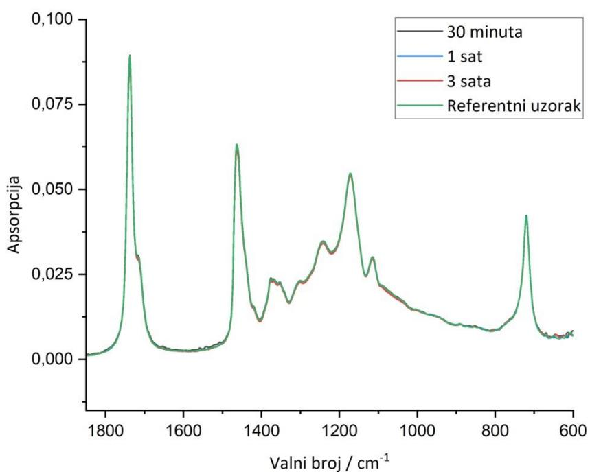
Grafikon 4.5. FTIR-ATR spektri uzorka 5ET tretiranog različitom duljinom trajanja toplinskog tretmana pri 140 °C (područje “otiska prsta”: 1800-600 cm<sup>-1</sup>)
