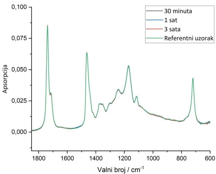
Grafikon 4.6. FTIR-ATR spektri uzorka 2CY tretiranog različitom duljinom trajanja toplinskog tretmana pri 160 °C (područje “otiska prsta”: 1800-600 cm<sup>-1</sup>)
