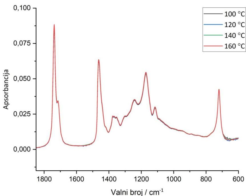
Grafikon 4.10. FTIR-ATR spektri uzorka 5ET tretiranog različitim temperaturama u trajanju toplinskog tretmana od 3 sata (područje “otiska prsta”: 1800-600  $\text{cm}^{-1}$ )
