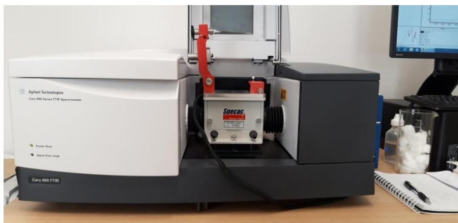
Slika 2.9. Infracrveni (FTIR) spektrometar s ATR instrumentalnim dodatkom
