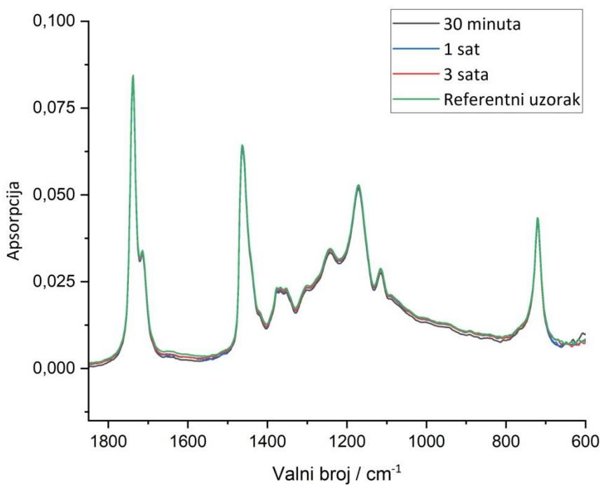
Grafikon 4.3. FTIR-ATR spektri uzorka 1NZ tretiranog različitom duljinom trajanja toplinskog tretmana pri  $100\text{ }^{\circ}\text{C}$  (područje “otiska prsta”:  $1800\text{-}600\text{ cm}^{-1}$ )
