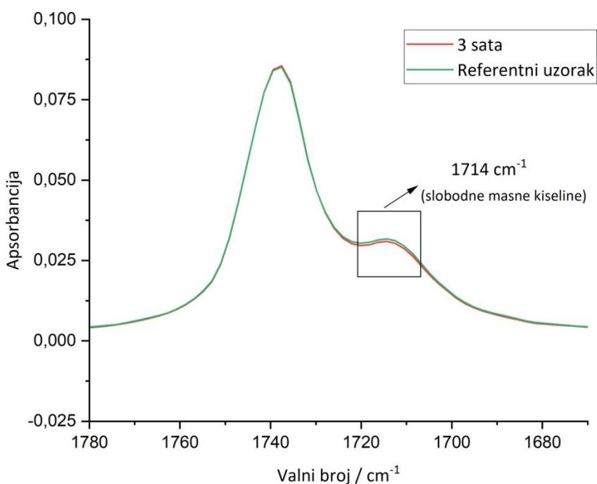
Grafikon 4.7. FTIR-ATR spektri uzorka 2CY tretiranog različitom duljinom trajanja toplinskog tretmana pri 160 °C (područje ramena: 1714 cm<sup>-1</sup>)
