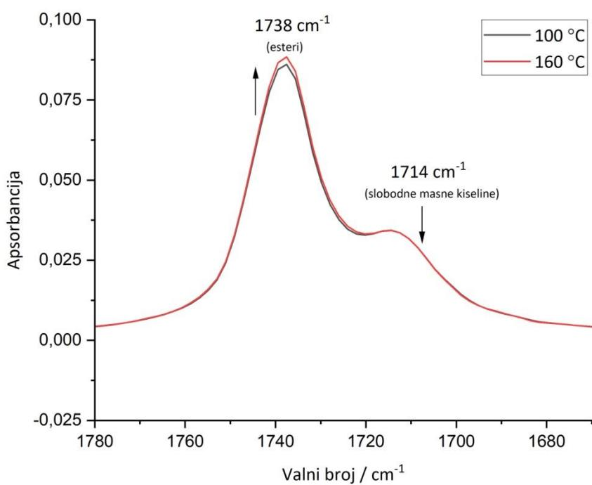
Grafikon 4.11. FTIR-ATR spektri uzorka 5ET tretiranog različitim temperaturama u trajanju toplinskog tretmana od 3 sata (područje ramena: 1714 cm<sup>-1</sup>)
