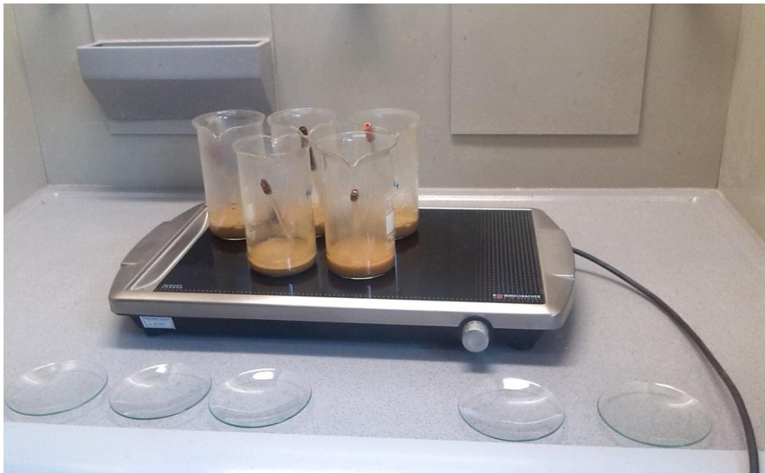
Slika 6: Zagrijavanje uzoraka radi razgradnje organske tvari
