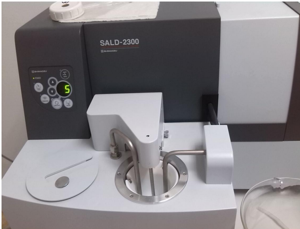
Slika 12: Laserski difraktometar SALD-2300
