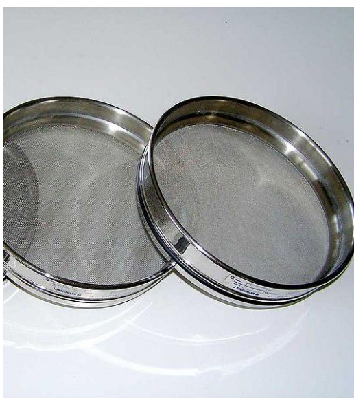
Slika 1: Sita za određivanje granulometrijskog sastava tla
