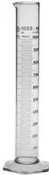
Slika 2: Cilindar za sedimentaciju od 1000 ml
