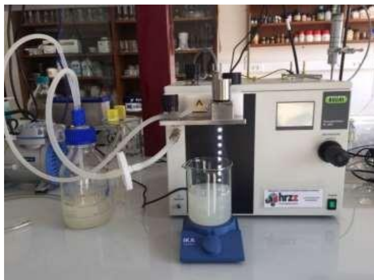
Slika 3.3.2.2. Uređaj za mikroinkapsulaciju, Encapsulator Büchi-B390, BÜCHI Labortechnik AG, Švicarska
