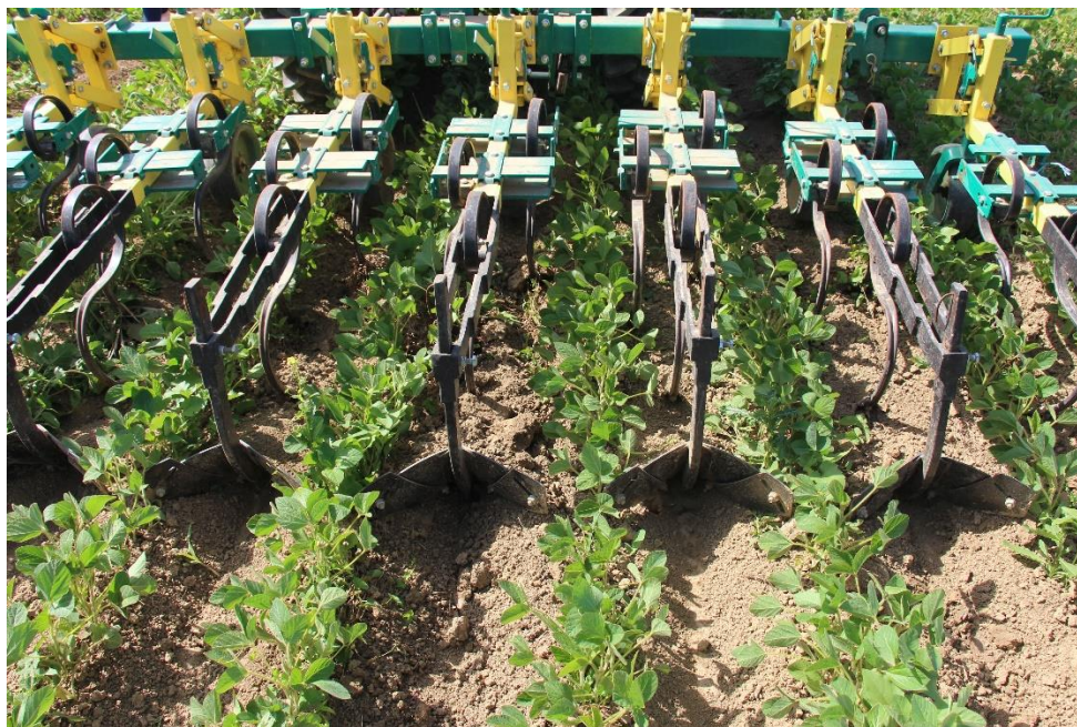
Slika 2.4.3.1. Međuredni kultivator UMK 8 sa ogrtačima.
