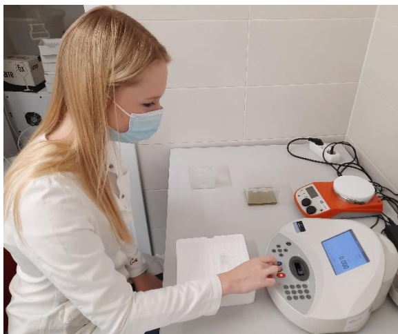
Slika 8. Određivanje parametara boje u vinu pomoću spektrofotometra Izvor: Brleković V.
