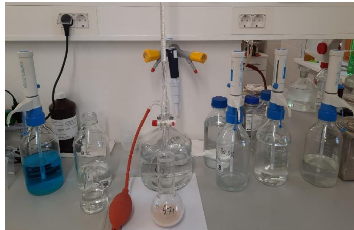
Slika 3. Aparatura za određivanje reducirajućeg šećera
