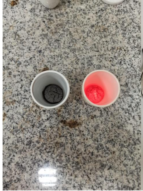
Slika 4.8. Posudice sa koksom nakon izgaranja u mufolnoj peći
