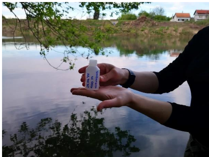
Slika 3.3.5. Uzimanje uzoraka vode iz rijeke Kupe 1 m nizvodno od ispusta uređaja za pročišćavanje otpadnih voda.
