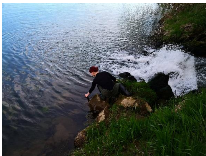
Slika 3.3.4. Uzimanje uzoraka vode iz rijeke Kupe 1 m nizvodno od ispusta uređaja za pročišćavanje otpadnih voda.
