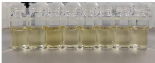
Slika 3.4.2.2. Uzorci vode iz rijeke Kupe s dodanim reagensima i u kivetama nakon očitavanja koncentracija amonijačnih iona na fotometru (Hanna Instruments).
