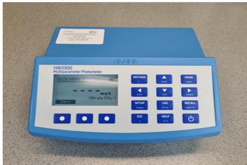
Slika 3.3.1.: Fotometar (HI83300 Multiparameter Photometer)
