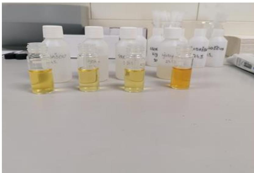
Slika 3.3.2.1.: Uzorci vode iz melioracijskih kanala s dodanim reagensima nakon očitavanja koncentracije amonija na fotometru
