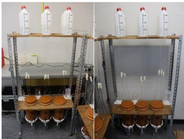
Slika 3.3.3.1. Sustavom umjerenog navodnjavanja kolona s tlom
