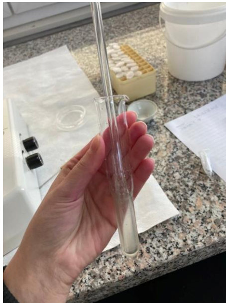
Slika 3.3.1. Drobljenje cista u Huijsmansovom homogenizatoru
