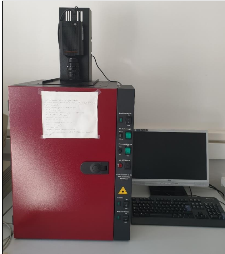
Slika 19. Uređaj za snimanje gela UVltech explorer Version 15.01
