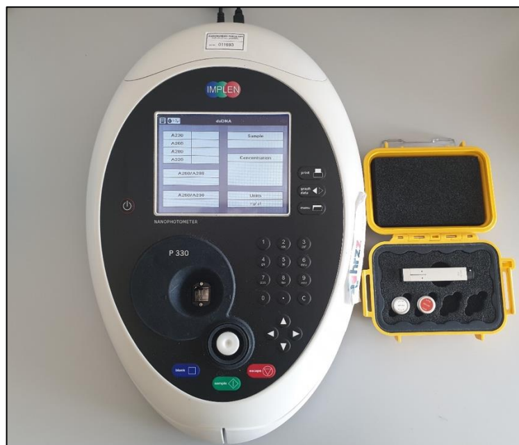
Slika 20. NanoPhotometer P330 Spektrofotometer
