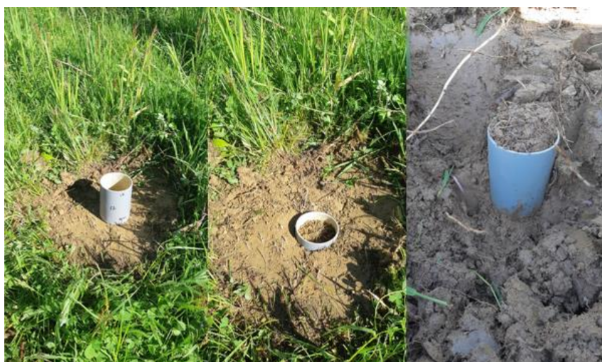
Slika 3.11. Uzorkovanje kolona tla za CT skeniranje poroznog sustava tla
