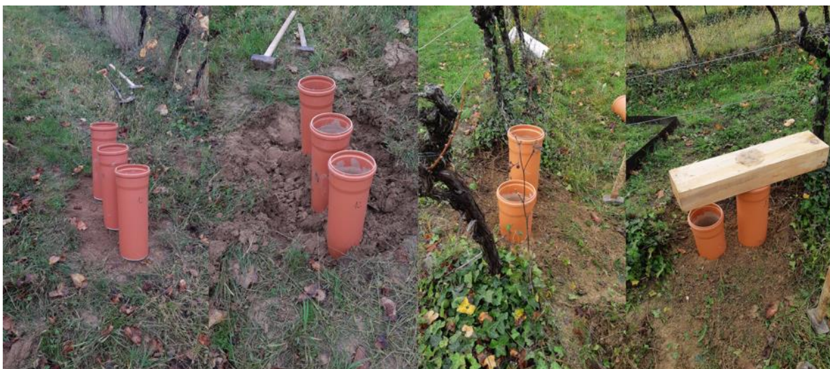
Slika 3.10. Uzorkovanje kolona tla u međuredu i redu na istraživanoj lokaciji
