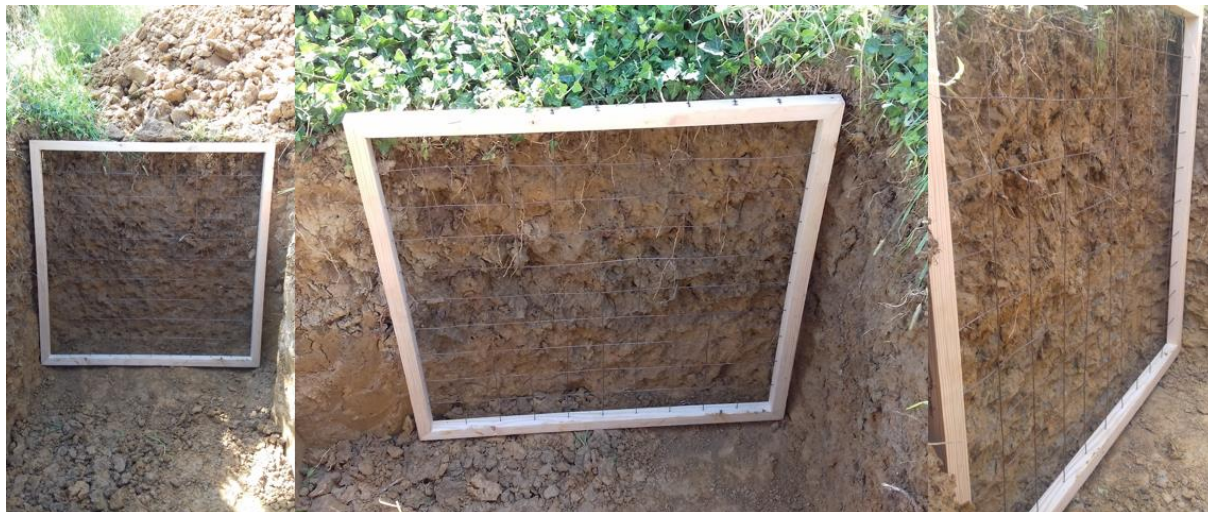
Slika 3.6. Analiza proraštenosti tla korijenom metodom lica profila na P2 poziciji
