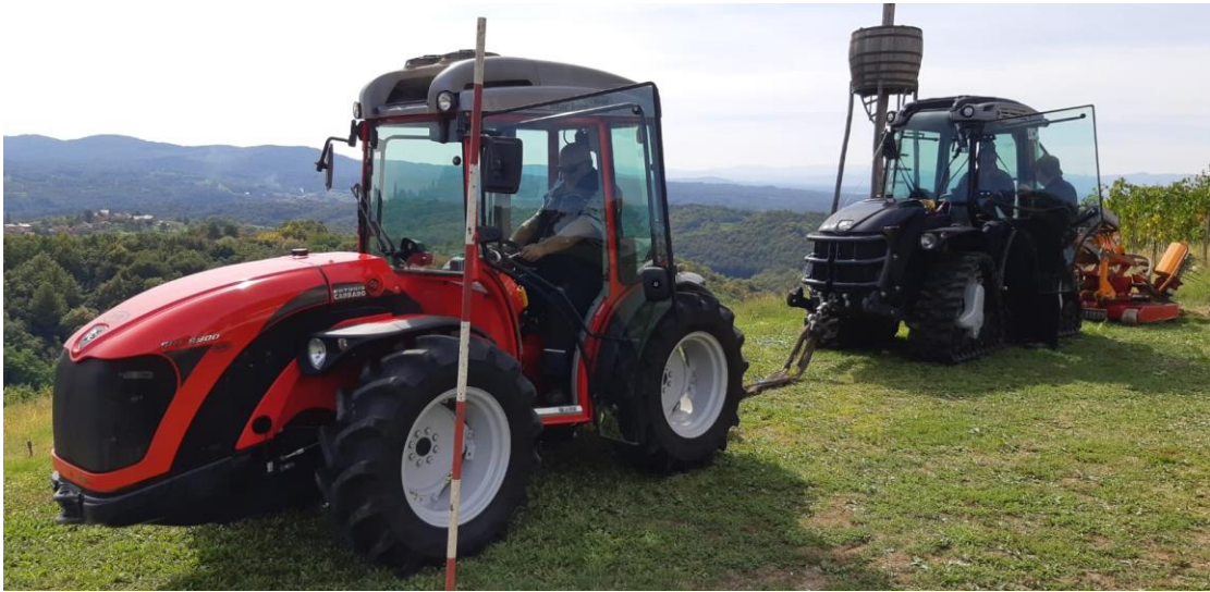
Slika 4.1. Ispitivanje vučne sile na ravnicima (Antonio Carraro SRX 9900)
