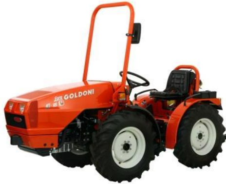
Slika 2.8. Voćarsko vinogradarski traktor sa zaštitnim lukom
