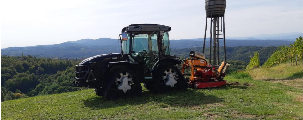
Slika 4.6. Održavanja pravca kretanja na bočnom nagibu Antonio Carraro MACH 4 R
