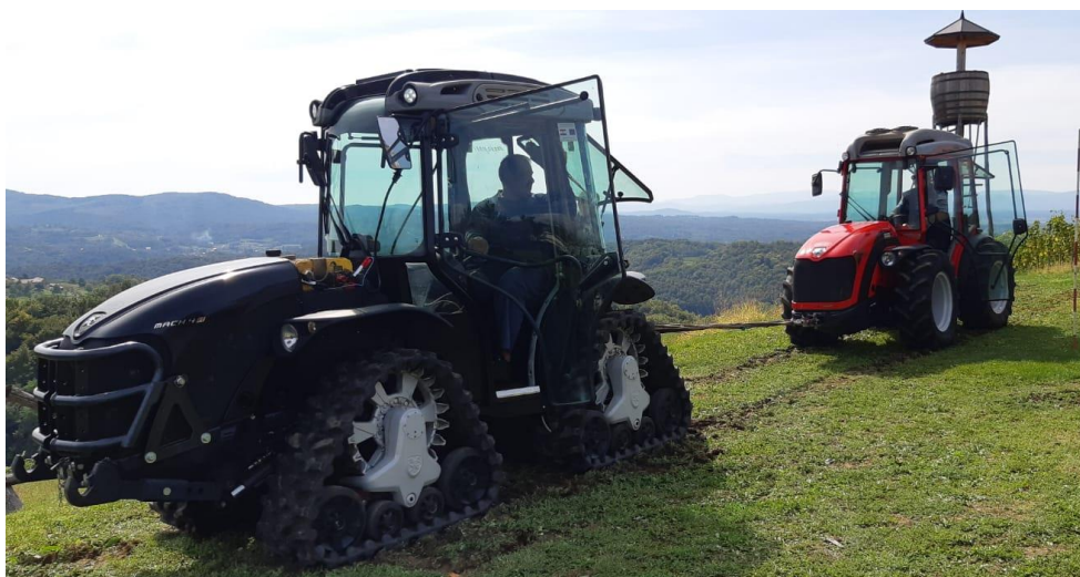
Slika 4.2. Ispitivanje vučne sile na ravnici (Antonio Carraro MACH 4 R)
