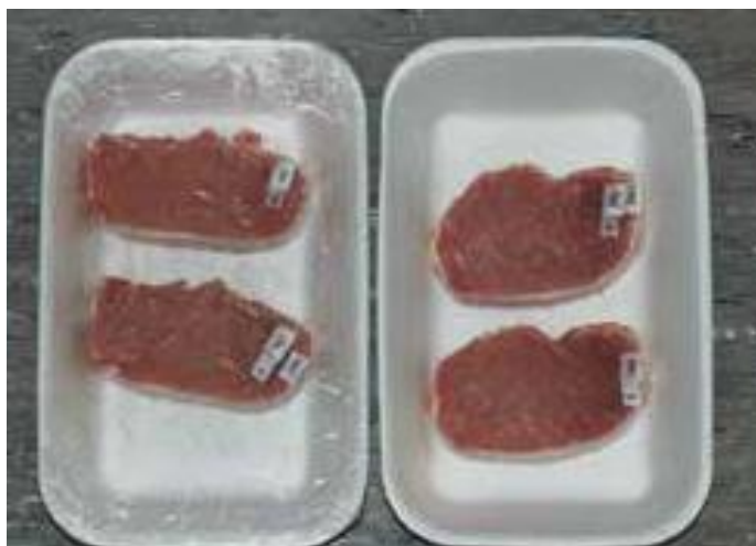
Slika 3.4. Prikaz uzoraka mesa na pladnjevima prilikom utvrđivanja SZV mesa metodom ladice
