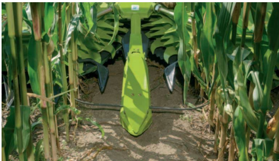
Slika 7.1. Mehanički osjetnici (tiala) na kombajnu
