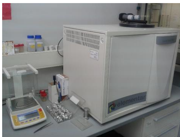
Slika 19. Vario, Macro CHNS analizator
