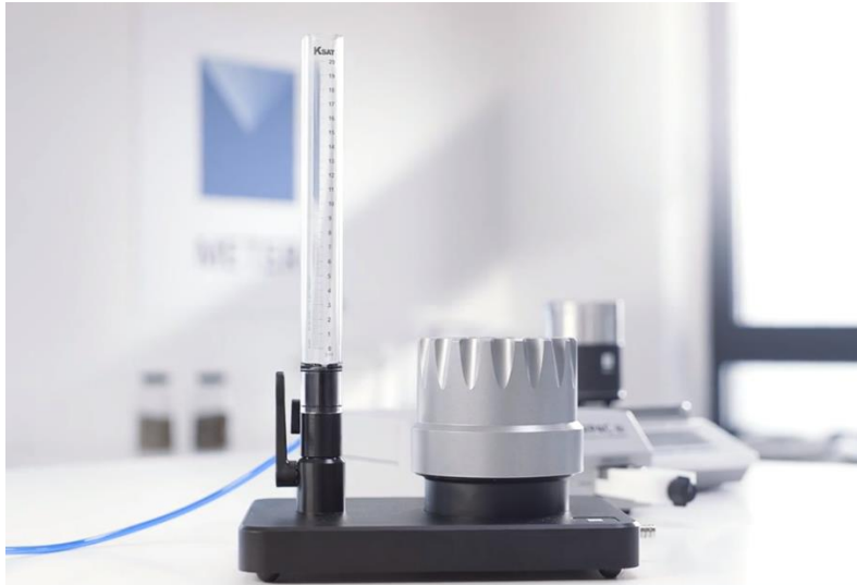
Slika 3.2.1.2. KSAT uređaj za mjerenje hidrauličke vodljivosti u saturiranim uvjetima Izvor: https://www.metergroup.com/environment/products/ksat-saturated-hydraulic-conductivity/
