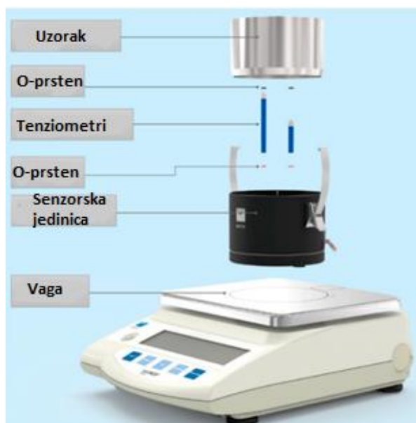
Slika 3.2.1.1. Prikaz HYPROP sustava za mjerenje hidrauličkih parametara tla na temelju evaporacijske metode
