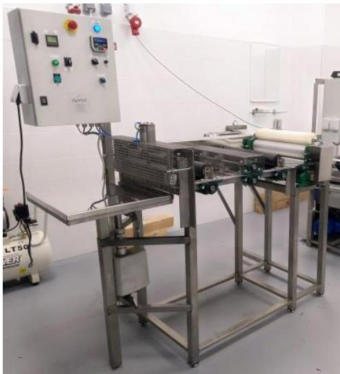
Slika 6. Valjak za izradu satnih osnova
