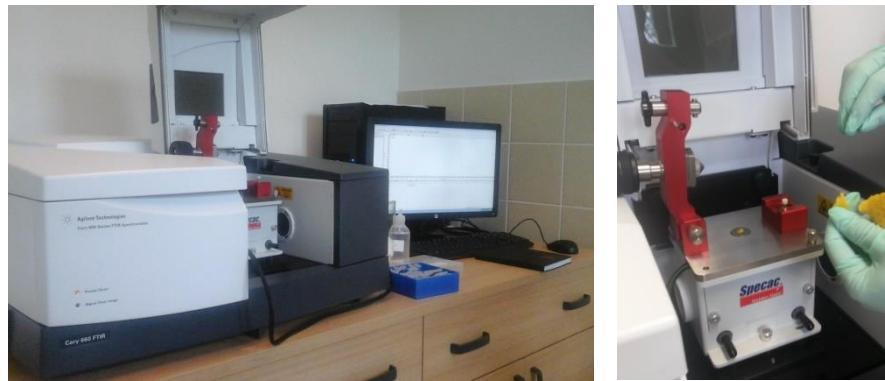
Slika 10. Infracrveni (FTIR) spektrometar s ATR instrumentalnim dodatkom (lijevo) i analiza uzoraka satne osnove FTIR-ATR tehnikom snimanja spektara (desno)
