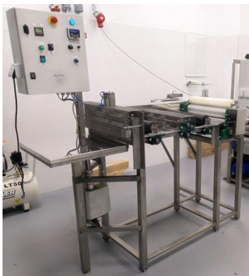
Slika 6. Valjak za izradu satnih osnova
