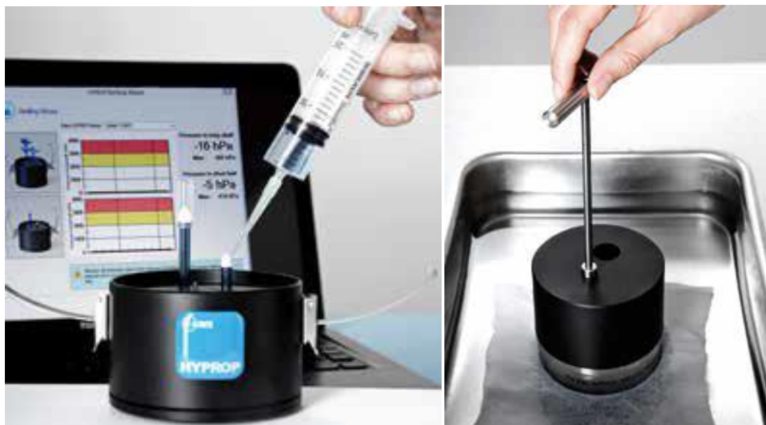
Slika 3.2.2.1.3. a) Tenziometri sa senzorskom jedinicom, b) Formiranje rupa u tlu Izvor: METER grupa, 2015.
