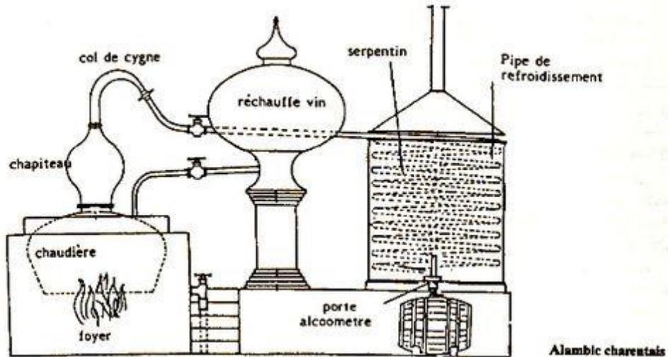
Slika 3.2. Dijelovi *alambic charentais*
