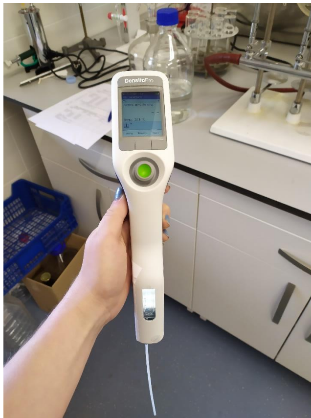
Slika 5.12. Uređaj za mjerenje alkoholne jakosti DensitoPro
