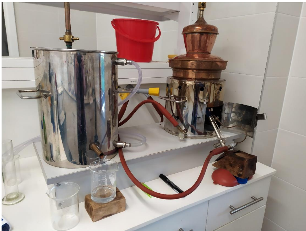
Slika 5.3.1. Jednostavni destilacijski uređaj kapaciteta 5L
