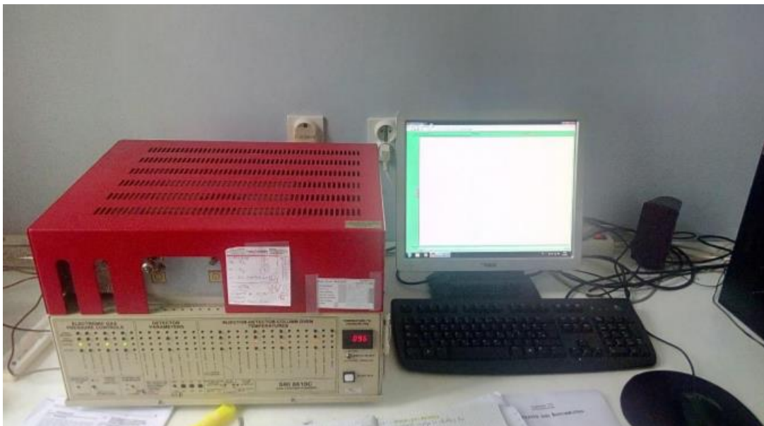
Slika 5.17. Plinski kromatograf s FID detektorom Zavoda za kemiju, Sveučilište u Zagrebu Agronomski fakultet
