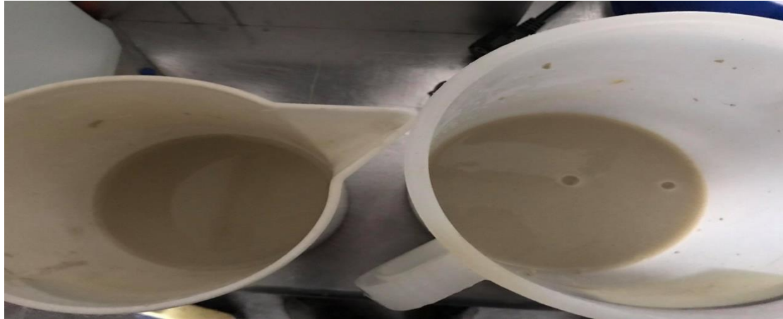
Slika 9. Pripremljeni bentonit nakon 24 sata namakanja u vodovodnoj vodi
