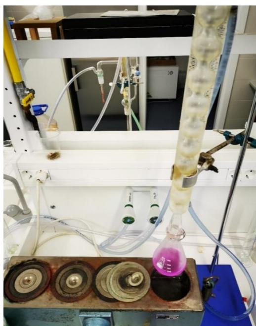
Slika 2.7. Analiza uzorka u parnoj kupelji sa povratnim hladilom
