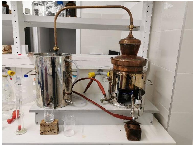
Slika 3.5. Korišteni 'Alambic' destilacijski uređaj
