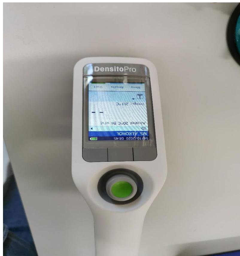
Slika 3.6. Korišteni digitalni refraktometar
