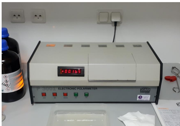
Slika 10: KRÜSS P3001 polarimetar Izvor: vlastita fotografija (Marko Gabor, 2020.)
