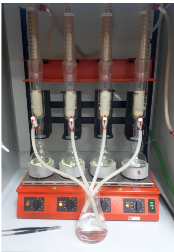
Slika 11: Soxhlet R 304 ekstraktor Izvor: vlastita fotografija (Marko Gabor, 2020.)
