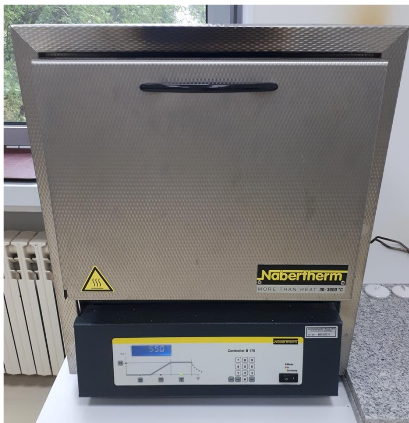
Slika 7: Nabertherm B 170 mufolna peč Izvor: vlastita fotografija (Marko Gabor, 2020.)
