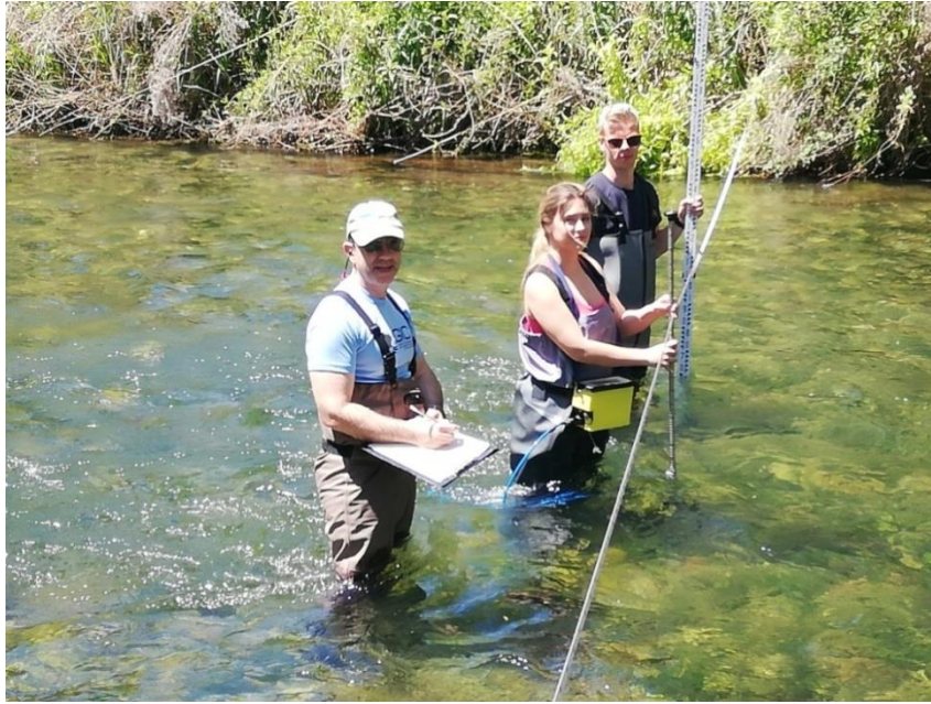
Prikaz mjerenja brzine vode pomoću elektro-magnetskog uređaja Izvor: Erceg; Noguera Ribagorzana, Španjolska
