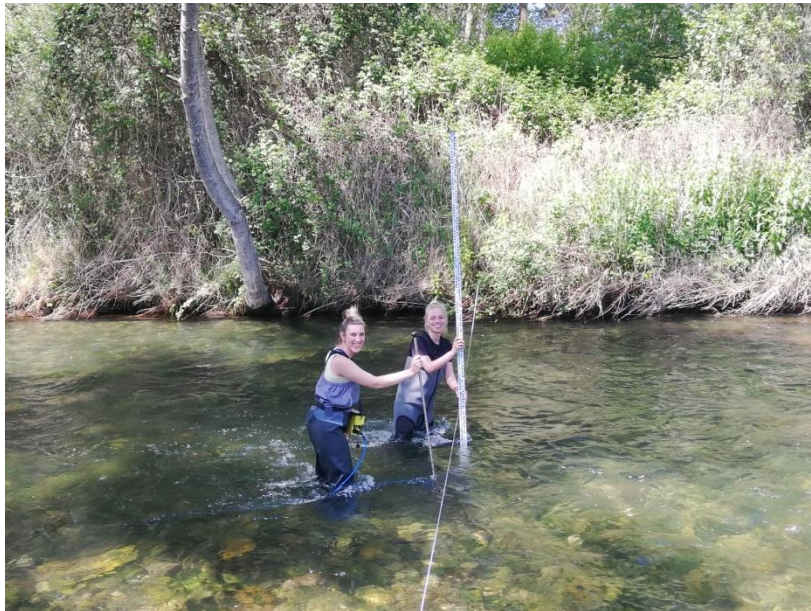
Pravilno pomicanje i postavljanje mjerača razine vode svakih 1 metar Izvor: Erceg; Noguera Ribagorzana, Španjolska
