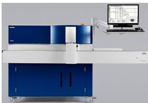
Slika 4.2.1. Bactoscan FC instrument za protočnu citometriju
