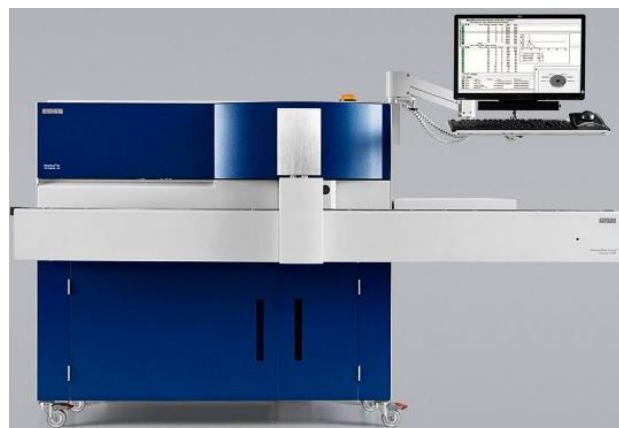
Slika 4.2.1. Bactoscan FC instrument za protočnu citometriju
