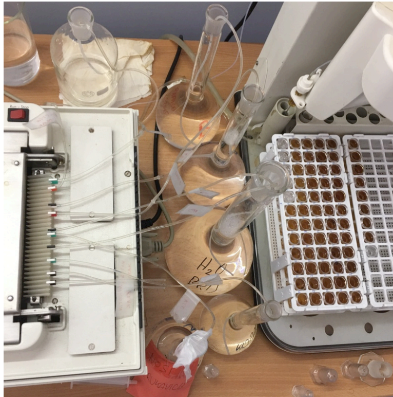
Slika 4.5.9. Protočni sustav automatskog analizatora SEAL Analytical AA3
