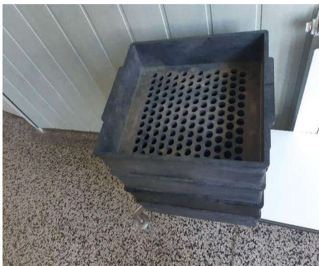
Slika 8. Separator za čestice, pravilno postavljena sita jedno iznad drugog
