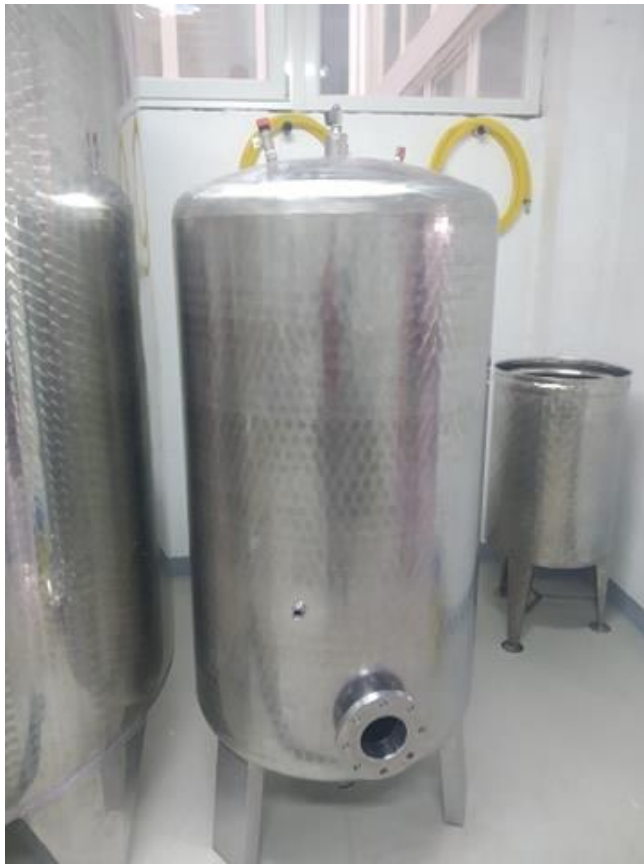
Slika 3. Inox tank za provedbu karbonske maceracije (pivovara Buzdovan 06. 9. 2019.)
