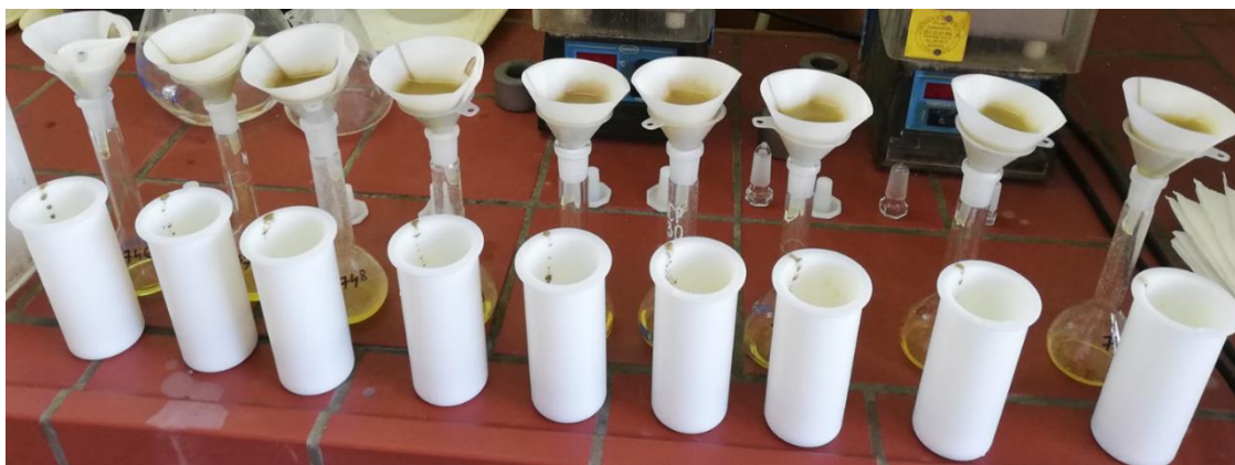
Slika 6. Filtriranje kisele otopine uzorka
