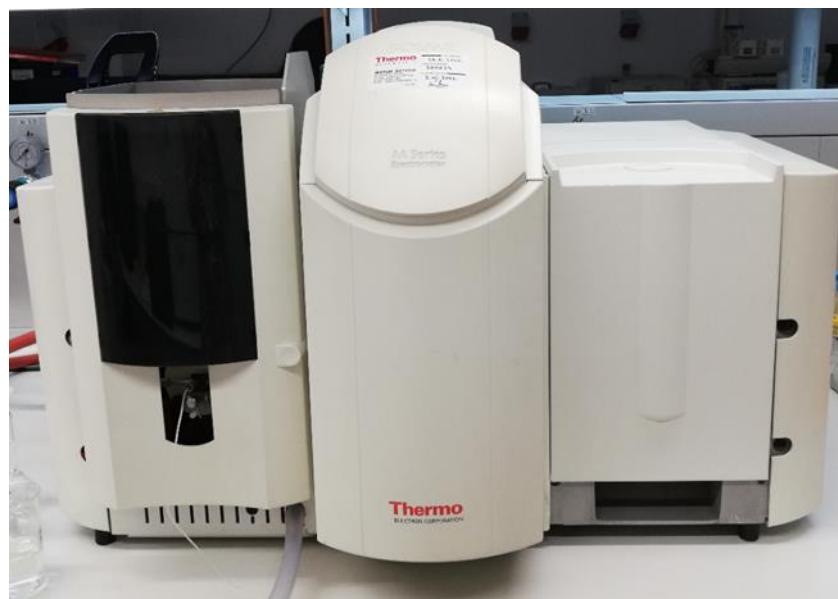
Slika 7. Atomski apsorpcijski spektrofotometar
