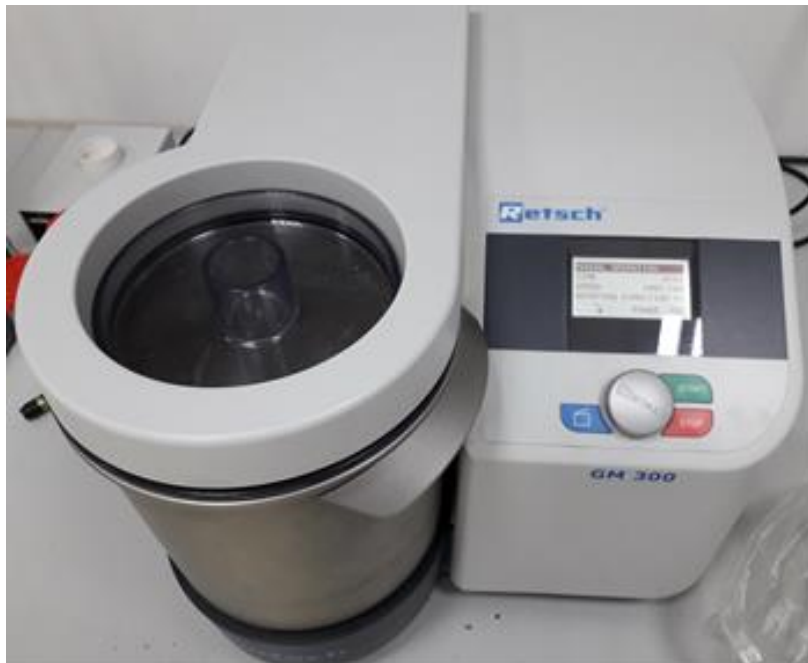
Slika 2. Laboratorijski mlin korišten za usitnjavanje rezidbenih ostataka
