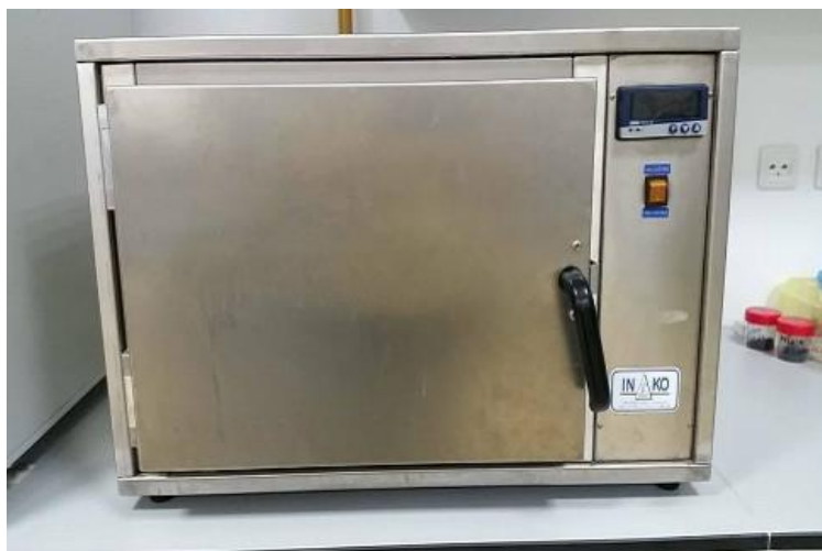
Slika 4. Sušnica za sušenje uzoraka
