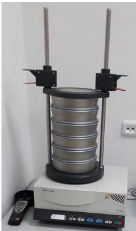
Slika 3. Laboratorijsko sito korišteno za odvajanje frakcija određenih veličina
