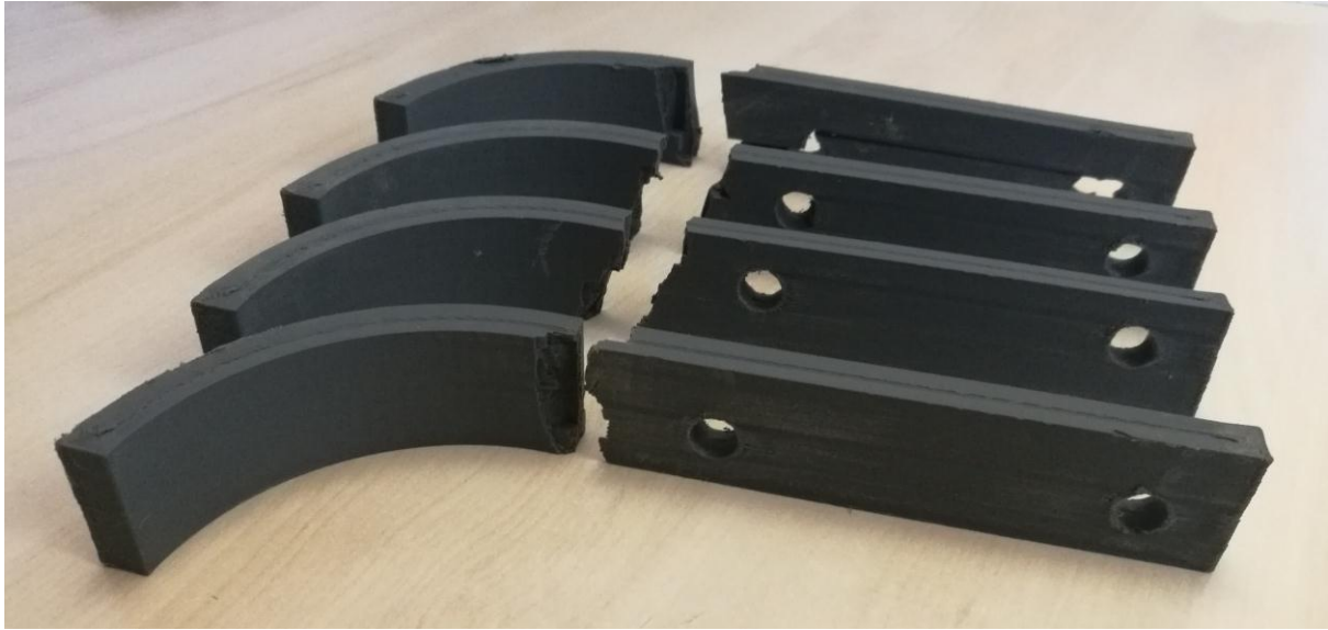
Slika 5.18. Lom PLA noževa
