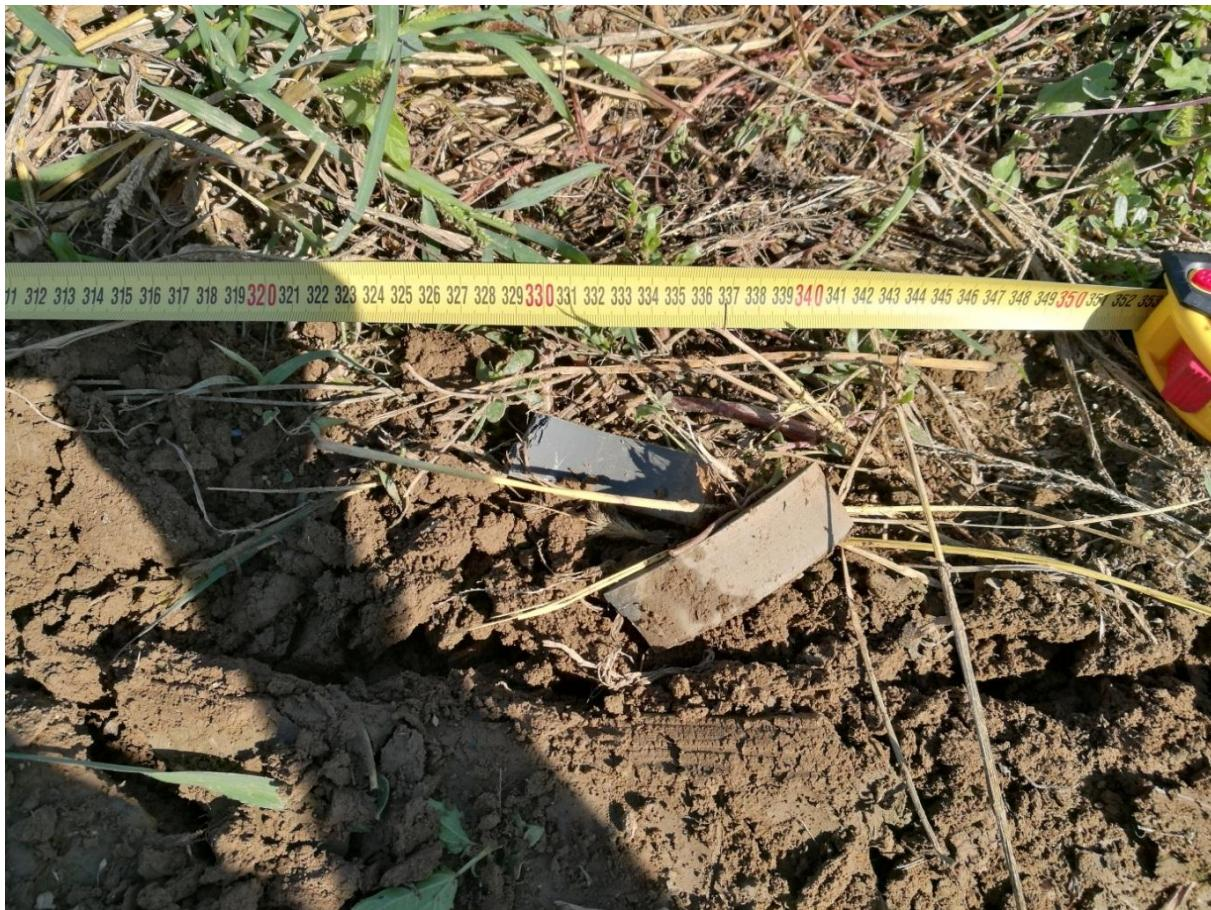
Slika 5.17. Odlomljeni noževi na trećem metru obrade
