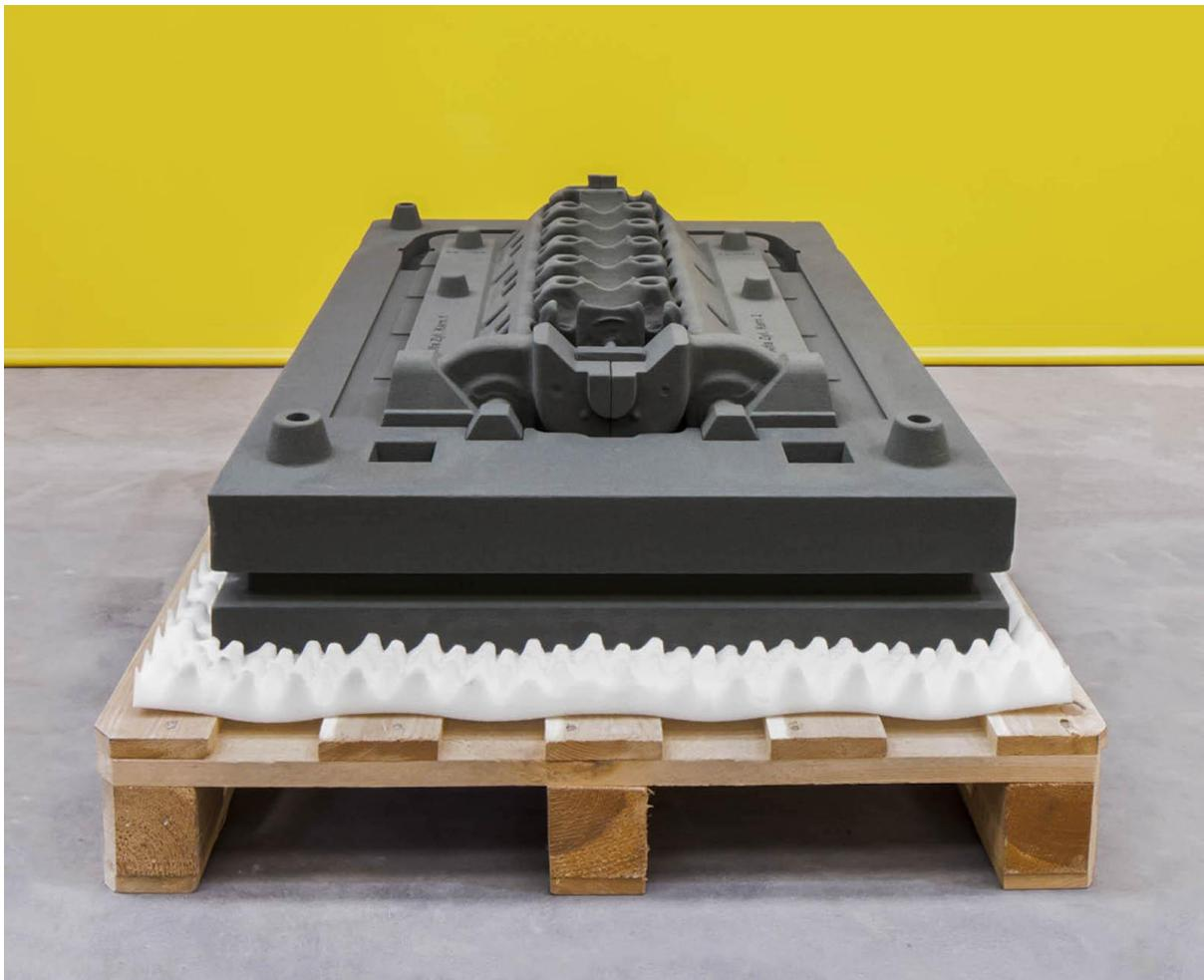
Slika 3.15. Višedjelni pješčani kalup za lijevanje bloka motora nastao SBJ metodom 3D ispisa
