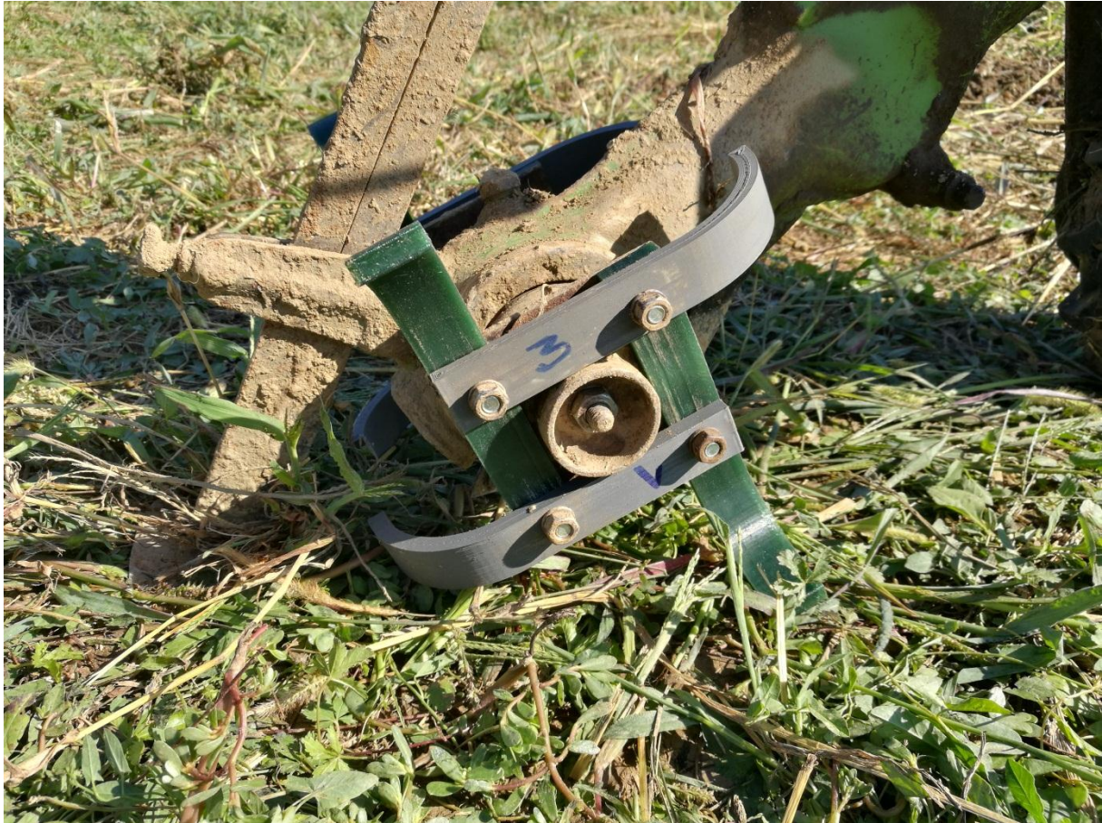
Slika 5.14. PLA (sivi) i PETG (zeleni) noževi postavljeni na motokultivator IMT 504 Izvor: vlastita slika
