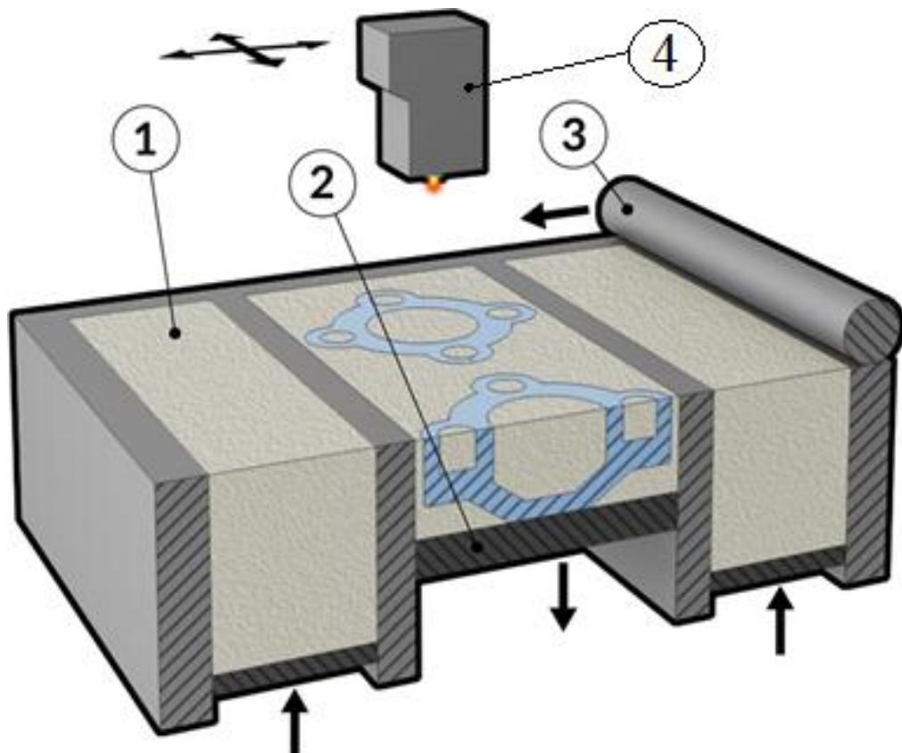
Slika 3.9. Dijelovi SHS 3D ispisivača
