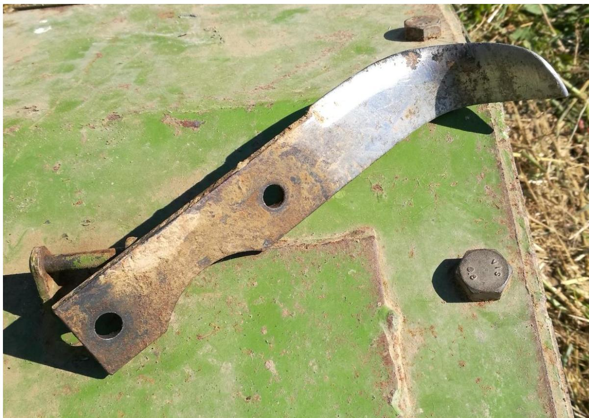
Slika 5.12. Standardni čelični nož debljine 5 mm
