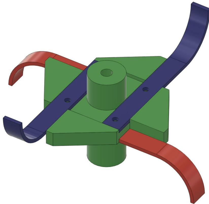
Slika 5.11. Potporne strukture za ojačavanje noževa projektirane u CAD programu
