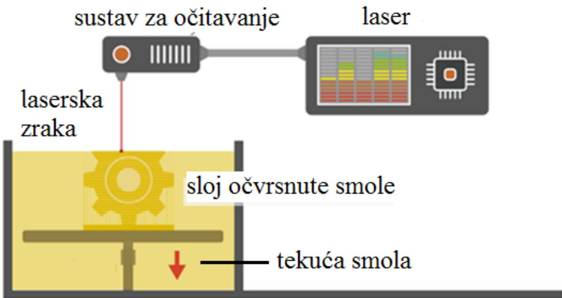
Slika 3.5. Dijelovi stereolitografskog 3D ispisivača
