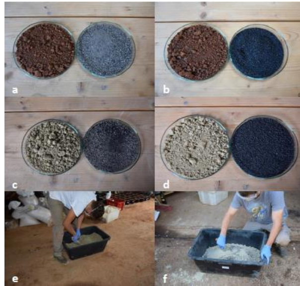
Slika 3.3.1. Korišteni materijali za pripremu supstrata (a) crvenica + biočar od mulja i b) crvenica + biočar od komine; c) rendzina + kompost od mulja i d) rendzina i kompost od komine te e) i f) miješanje istih
