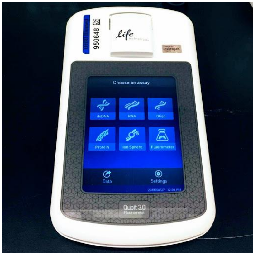
Slika 3.3. Qubit instrument za određivanje proteina (izvor: Dominik Anđelini)
