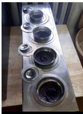
Slika 14: Određivanje pepela u vinu Izvor: Osobni arhiv
