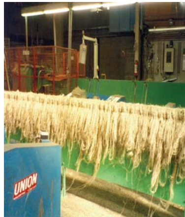
Slika 45. Dugo vlakno na izlasku iz turbine
