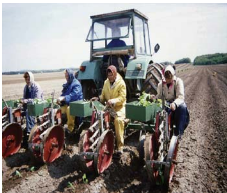
Slika 92. Sadnja duhana poluautomatskom četverorednom sadilicom
