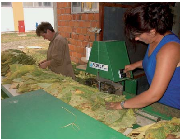
Slika 138. Strojno nizanje duhana tipa burley prije sušenja
