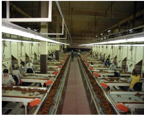
Slika 127. Odvajanje nečistoća i zelenog duhana na pokretnoj traci
