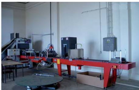
Slika 65. Stroj za sjetvu plitica
