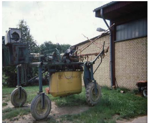
Slika 105. Stroj za zalamanje duhana
