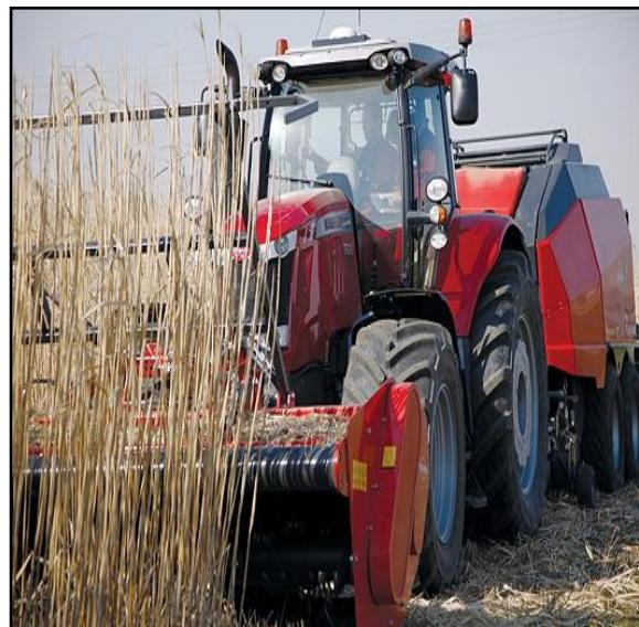
Slika 13. Jednofazna žetva s dva agregata, prednji priključni krmni kombajn i preša (Izvor: [www.wnif.co.uk](http://www.wnif.co.uk))
