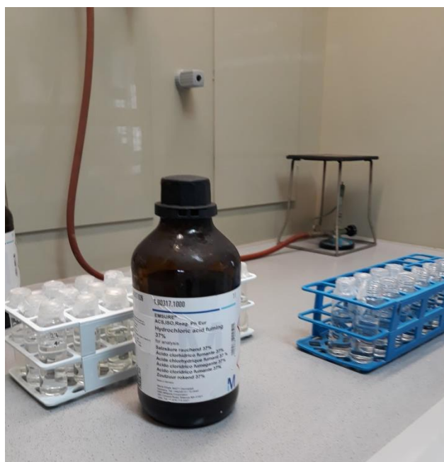
Slika 4.1.3. 37%-tna HCl za zakiseljavanje uzoraka vode
