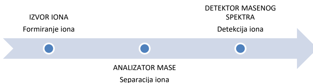
Slika 3.1.1. Prikaz koraka u analizi spektrometrijom masa
