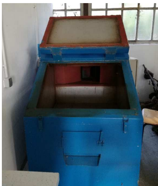
Slika 13. Uređaj za kondukcijsko sušenje (Izvor: vlastiti)
